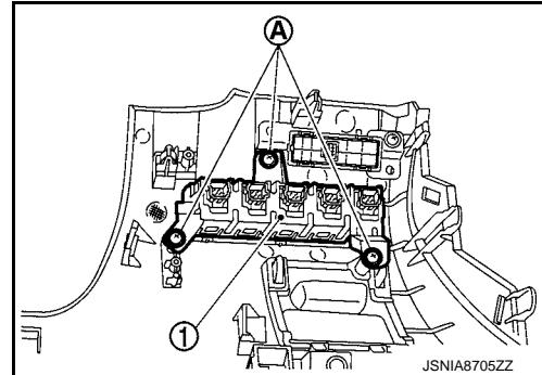
3. 拆下仪表控制开关装配螺丝 ③, 然后拆下仪表控制开关 ②。
